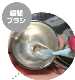
歯間 ブラシ 絵具カップからノズルまでの 通り道の洗浄。洗浄液をカッ プ内へ入れごしごしこすって あげてください。
