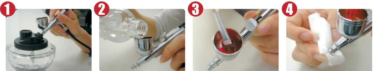
塗料カップに残った塗料を捨てます。ジェリーフィッシュを使えば、噴射した余分なミストを気にせず排出することができます。
